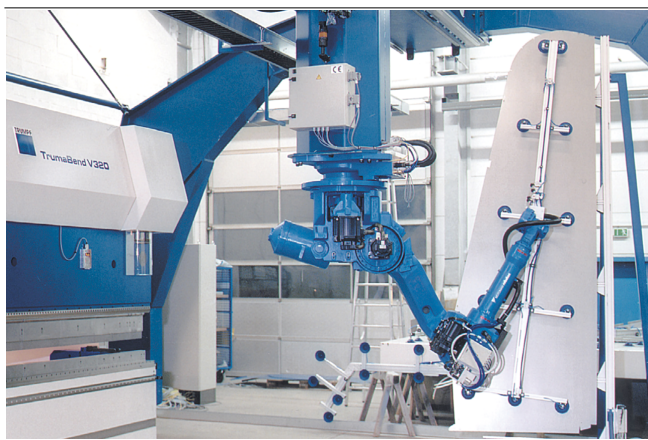
Плоские присоски SAF, используемые для перемещения деталей из листового металла
